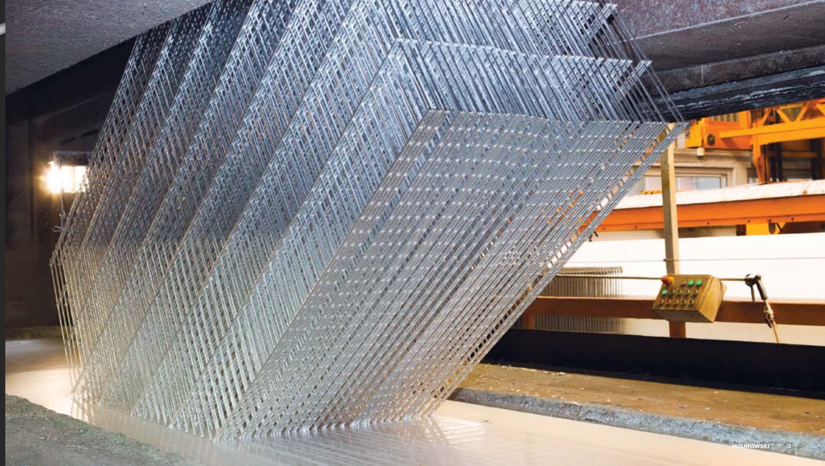
Trådnetpanel beskyttet med: varmgalvanisering
